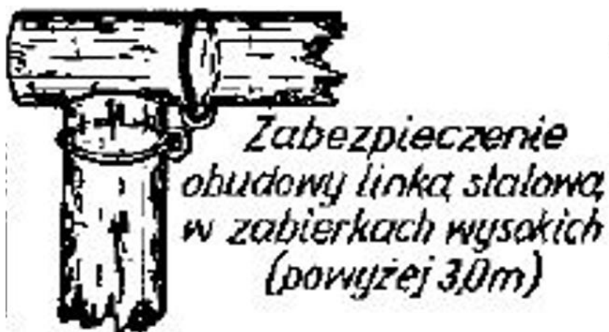
Rys. 13. Zabezpieczanie stojaka przed wybiciem w wysokiej zabierce.
