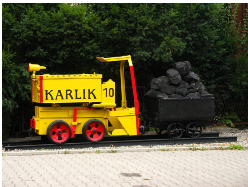
Podziemna akumulatorowa lokomotywa przed bramą kopalni Rydułtowy; zdjęcie: autor.
