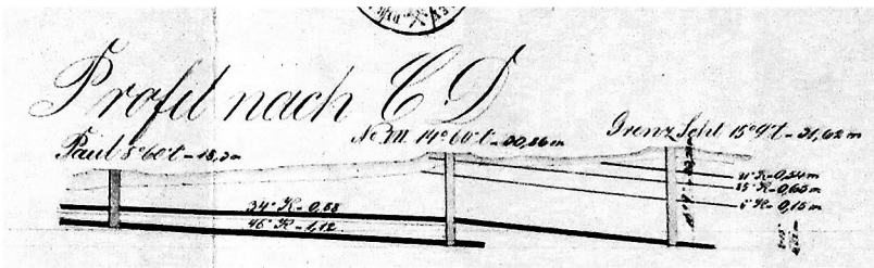
Przekrój przez szyb Paul, szyb sztolniowy VII i Grenz Scht. Pokazuje eksploatację ławy górnej pokładu Leopold i pokładu Hangende (środkowy wśród trzech cienkich).
