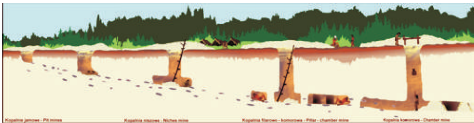
Rezerwat Archeologiczno-Przyrodniczy "Krzemionki Opatowskie" k. Ostrowca Świętokrzyskiego. Schematyczny profil poprzeczny pola eksploatacyjnego z różnymi typami kopalni. Grafika komputerowa K. Kaptur
