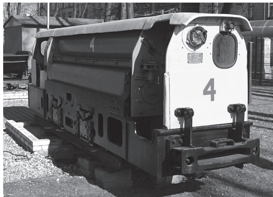
Fot. 5 i 6. Lokomotywa powietrzna JUNG. Ze zbiorów Muzeum Górnictwa Węglowego w Zabrzu
