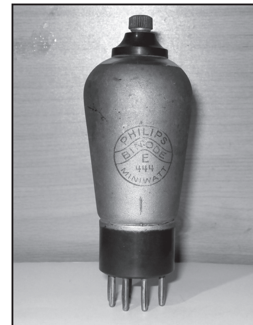
Fot.7. Lampa metalizowana z 1935 roku. Fot. Jan Habdas
