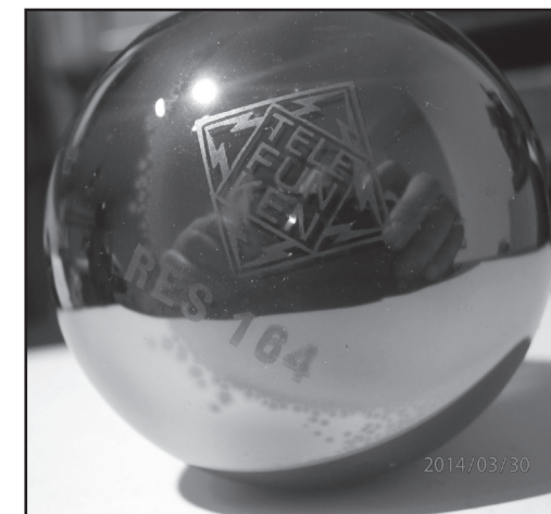
Fot. 5. Originalne oznaczenie lampy RES 164. Fot. Jan Habdas
