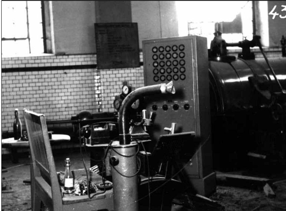
Fot. 6. Opuszczone w pośpiechu stanowisko maszynisty wyciągowego. Fot. ze zbiorów Archiwum Państwowego w Katowicach
