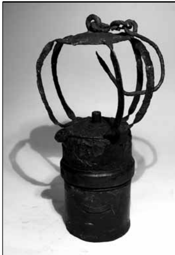
Fot. 2. Jedna z pierwszych lamp karbidowych używana w śląskich kopalniach produkowana przez firmę Friemann & Wolf w Zwickau ok. 1910 roku. Lampa ze zbiorów Romana Kłoska. Fot. Jan Jurkiewicz
